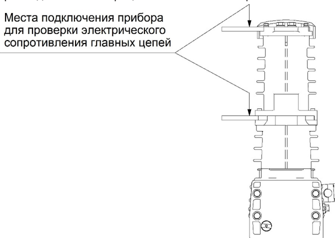
Рисунок 5 – Измерение переходного сопротивление главных цепей ВВ
